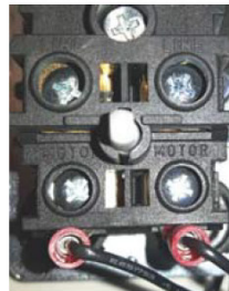
Anschluss des Zählermoduls an die Klemmen MOTOR / MOTOR
